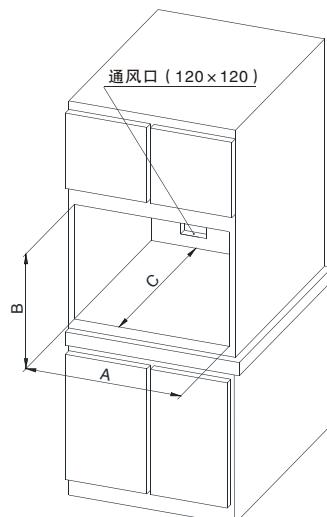
蒸汽炉外形尺寸图：
