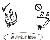
■ 请单独使用额定电流10A以上的插座，必须有可靠接地。交流电压必须在187~242V之间，否则会导致蒸汽炉无法正常使用或其它意外情况。（图1）
